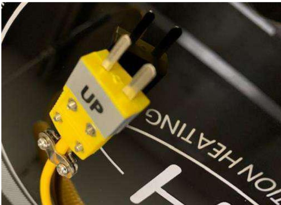
Ниже вид снизу плиты на правильно подключенный зонд. Надпись UP обращена вверх и не видна.
